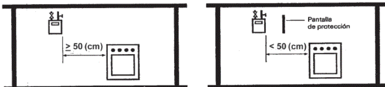
Figura 17. Distancia de seguridad con pantalla de protección.
