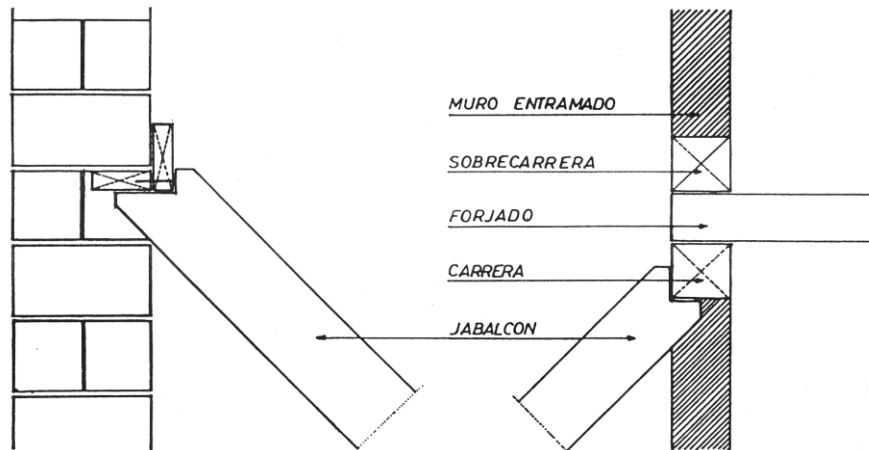
Fig 16: Colocación de muletillas para unión con el jabalcón
