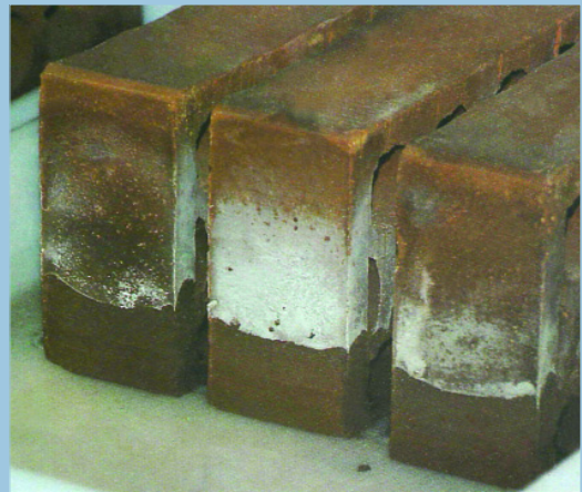
Ensayo de eflorescencia en ladrillos macizos.
