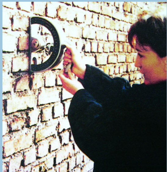
Realización de una prueba esclerométrica.
