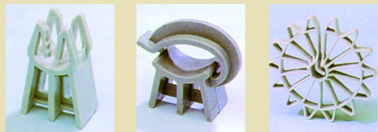
El uso de distanciadores es fundamental para lograr el recubrimiento mínimo protector de las armaduras. De izquierda a derecha: Universal, Ferropes Gancho y Ruver.
