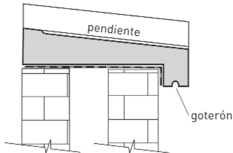
Sección donde se aprecia la pendiente de la junta trabada entre dos elementos.
