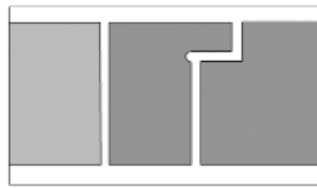
Canaleta que rompe la capilaridad para evitar que el agua llegue al interior y decante antes. No es la mejor solución.
