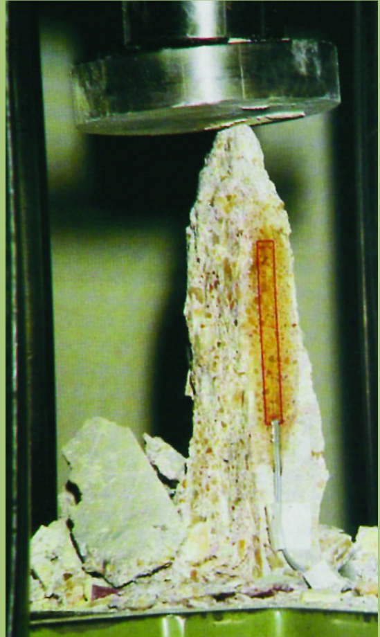
Ensayo sobre una probeta de piedra para determinar el módulo de elasticidad.
