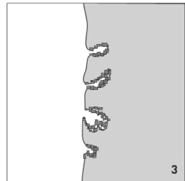
Evaporación del agua y permanencia de partículas en el interior de los poros.
