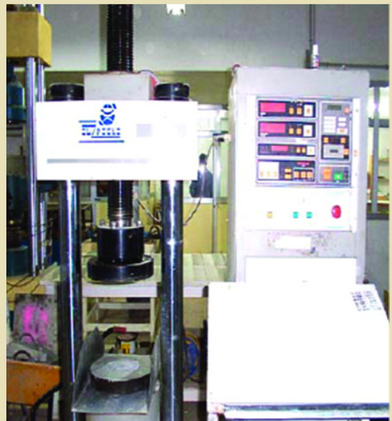
Elementos para ensayo de probetas de hormigón.
