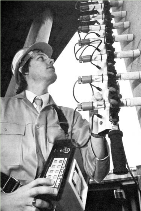
Realización de diagnosis de un pilar de hormigón armado dañado.
