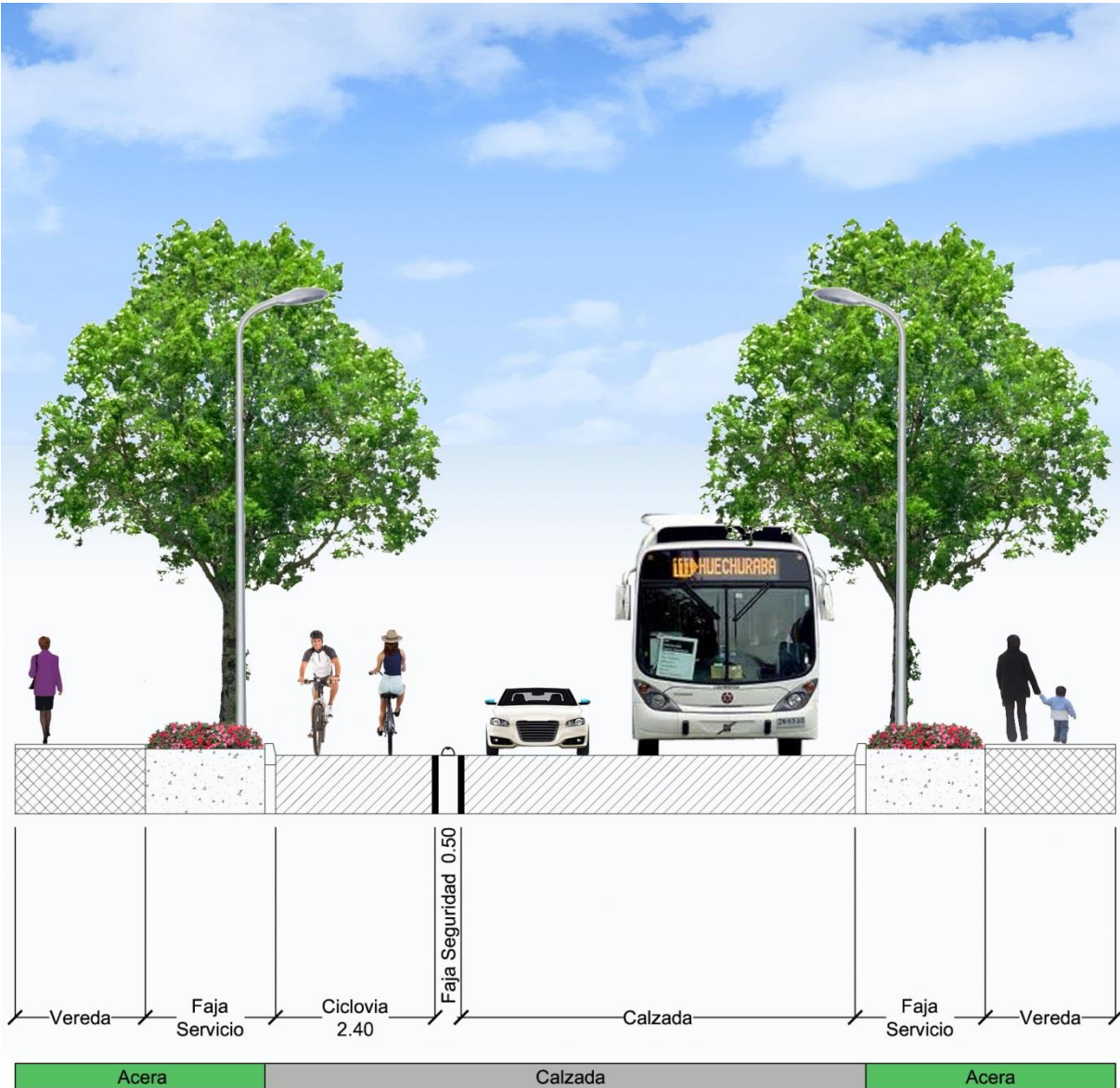
Figura 4.9.4 Bidireccional por un lado de la calzada.
