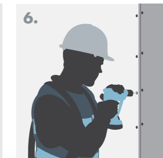
6. Fixing Knauf Fire Panel.
