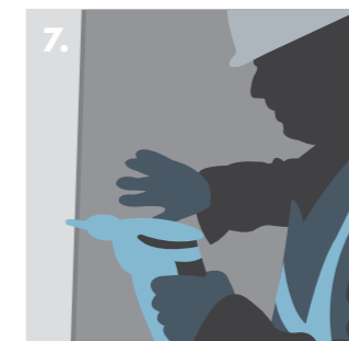
7. Fixing the 15mm Knauf Soundshield Plus to Knauf Acoustic 'C' Stud.
