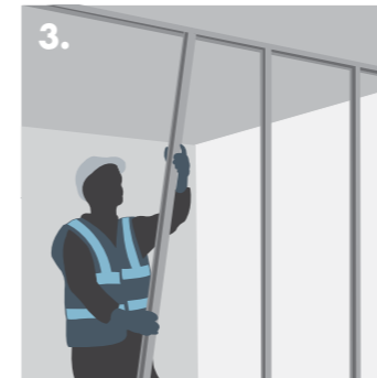
3. Twisting Knauf 'C' Stud into position.
