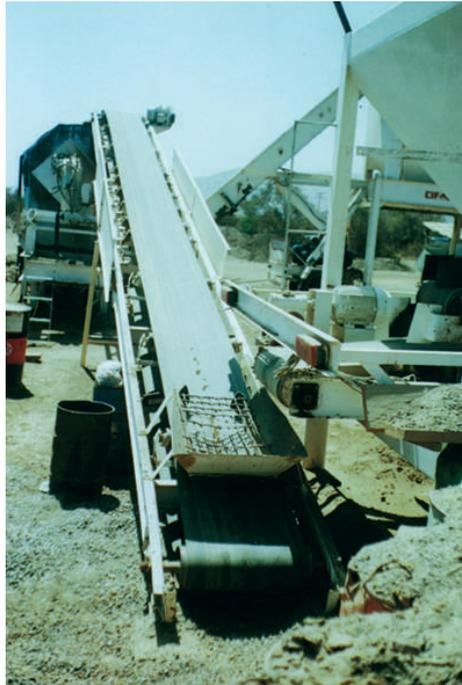
En la parte superior, por donde ingresa el árido, se encuentra el soplador-quemador que tiene como función principal secar completamente el árido.
