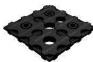
AMORTIGUADOR AISLADOR PAD TIPO API-M MARCA: AREFINE (INGLATERRA) ESPESOR: 10 MM. CAPACIDAD: 90 KG MATERIAL: GOMA 50 SHORE A UNIDAD DE VENTA: UNITARIO
