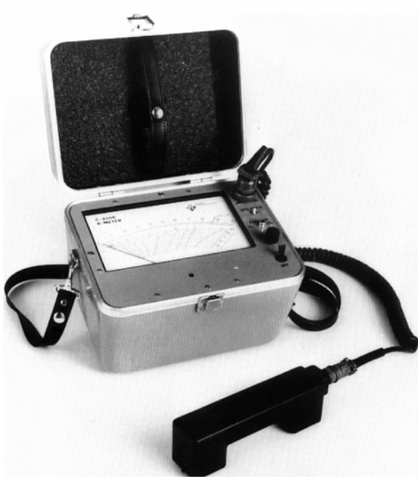
Fig. 2-3 – Pacómetro (localizador de armaduras) (cortesía de James Instruments)
