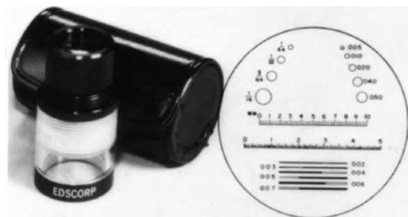
Fig. 2.1 – Comparador para medir anchos de fisura (cortesía de Edmund Scientific Co.)
