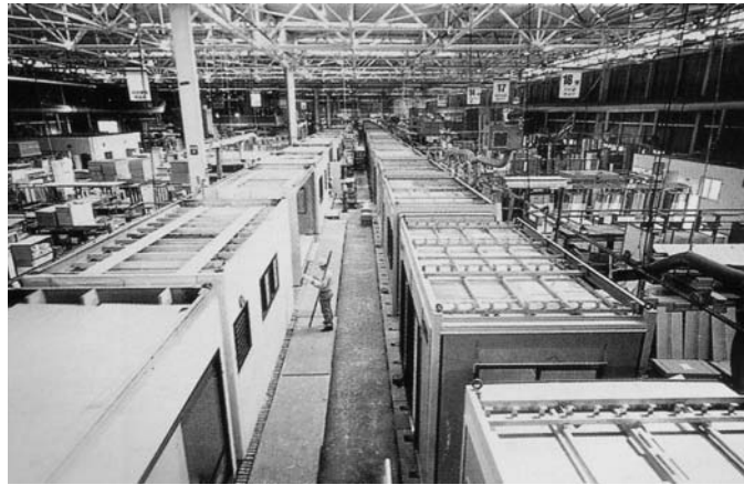
Foto 2.5- Línea de montaje de módulos residenciales en Japón. (Fuente: SCI)
