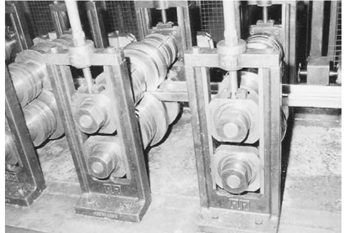
Foto 2.24 - Fabricación por perfilado de perfiles de sección C. (Fuente: SCI)
