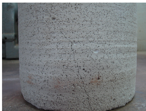
Figura N° 5.20: Probeta N°2 fisurada al enfriarse después de secado en horno a 110°C
