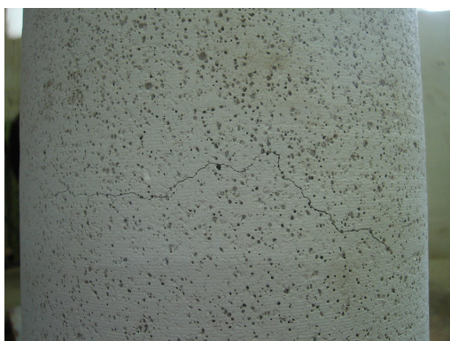
Figura N° 5.20: Probeta N°2 fisurada al enfriarse después de secado en horno a 110°C
