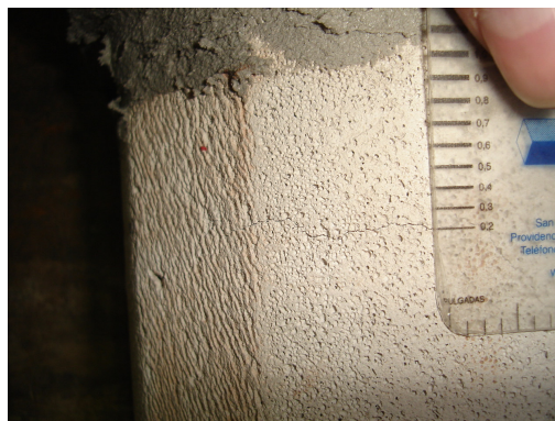
Figura N° 5.19: Probeta N°1 fisurada al enfriarse después de secado en horno a 110°C
