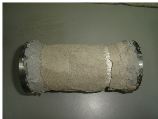
Figura N° 6.37: Ensayo a tracción de solución de reparación testigo 4
