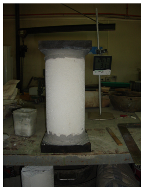
Figura N° 5.19: Probeta N°1 fisurada al enfriarse después de secado en horno a 110°C
