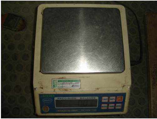
Balanza, precisión de 0,1 g
