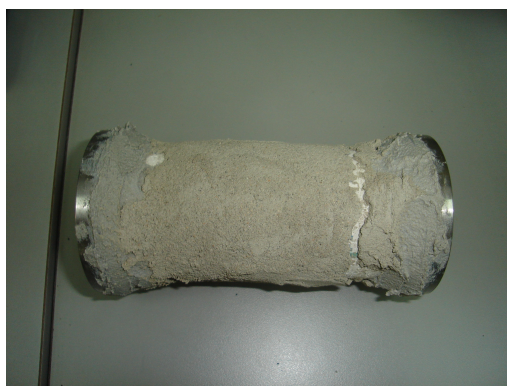
Figura N° 6.38: Ensayo a tracción de solución de reparación testigo 5
