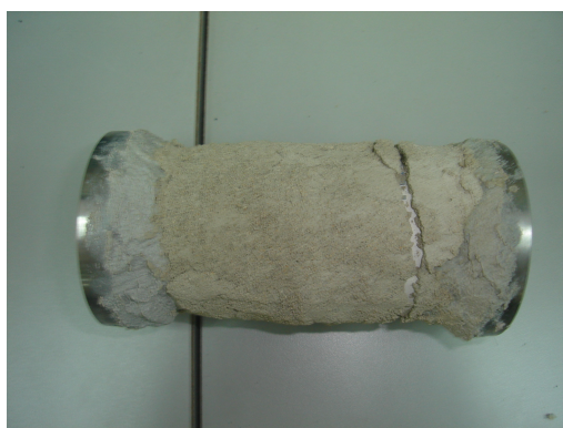
Figura N° 6.39: Ensayo a tracción de solución de reparación testigo 6
