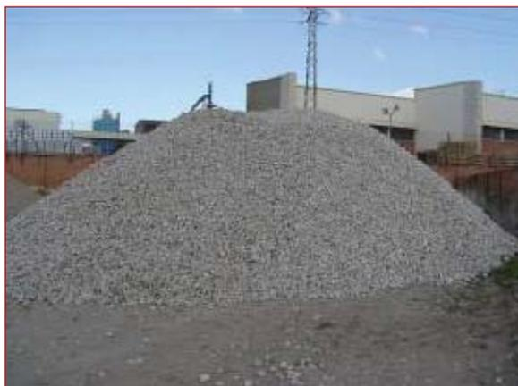
**Figura 8.76. Acopio de áridos reciclados.**
