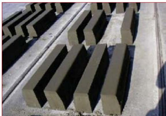
**Figura 8.3. Bordillos fabricados a partir de áridos reciclados.**
