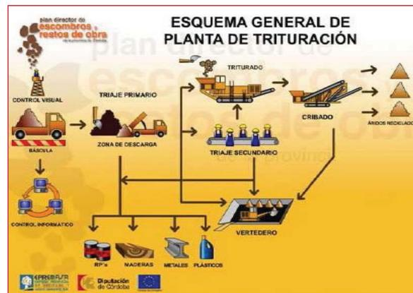
Figura 7.1. Esquema de la planta de tratamiento de RCD adoptada.
