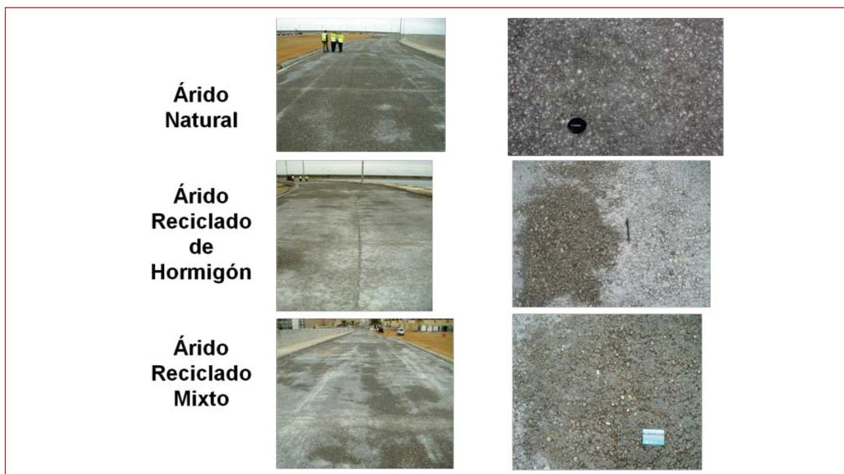
**Figura 8.59. Aspectos de los distintos tipos de hormigón tras la compactación.**
