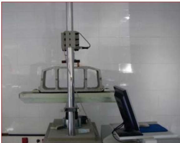
**Figura 8.16. Ensayos de flexión sobre la bovedilla.**
