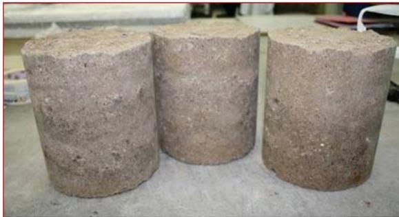
**Figura 7.17. Probetas de suelocemento antes de su rotura – Serie II.**
