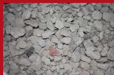
Áridos reciclados como material tratado con ligantes hidráulicos en prefabricados
