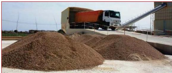
**Figura 8.46. Acopio de áridos reciclados mixtos.**
